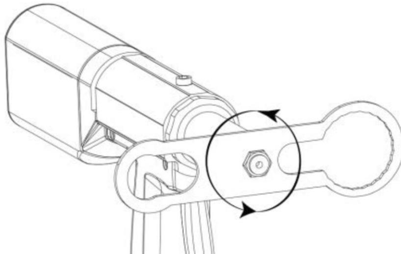
Б) Выберите нужную насадку (из прилагающегося комплекта деталей), вкрутите её в инструмент, и затяните гаечным ключом:
