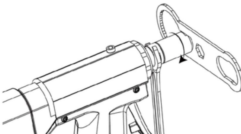
5) Вытащите *губки* (4) из *патрона* (3); достаньте *толкатель* (5) и *пружину толкателя* (6) из инструмента; почистите все эти детали или при необходимости (по мере износа) замените их на новые.
