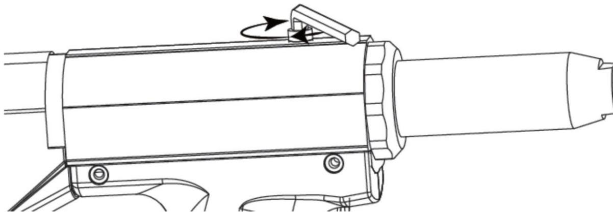
После длительного использования инструмента в его носовой части может скапливаться металлическая стружка от заклепок, что может снизить эффективность работы инструмента. Поэтому рекомендуется периодически очищать или заменять расходные детали носовой части инструмента.
